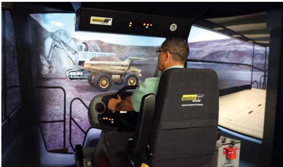
*Simulador de equipamento de mina, com kit de caminhão off road, usado pela Vale*
